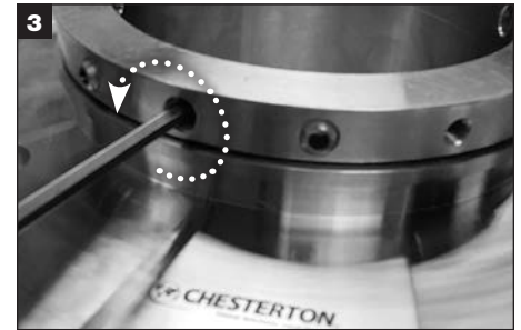
Déposez toutes les vis sans tête à cuvette et à téton de la bague de verrouillage et mettez-les au rebut.
