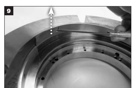
Déposez tous les ressorts des orifices de ressort du chapeau et mettez-les au rebut.
